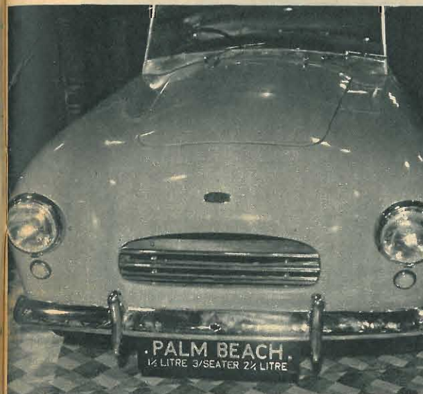
● L'Allard Palm Beach viene costruita in due versioni con motore da 1500 o da 2260 cc (ambidue i tipi vengono fabbricati dalla Ford inglese).
